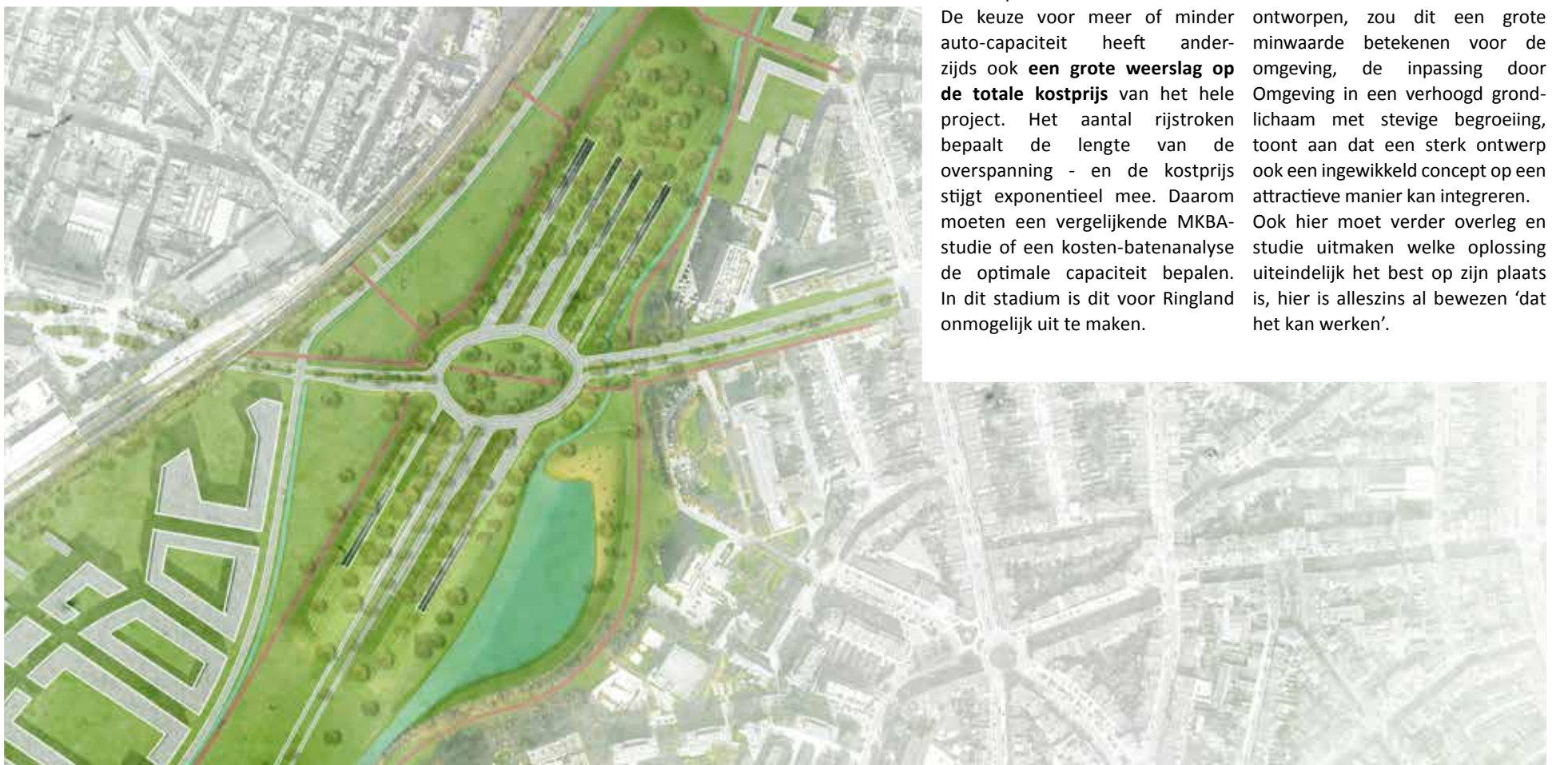
↑ De turborotonde is het infrastructuurconcept dat de grootste capaciteit kan verwerken. Het is hier toegepast op het drukste kruispunt (Plantijn en Moretuslei). Een sterke landschappelijke integratie kan ook dit deel van Ringland een eigen karakter geven (meer heuvelachtig en bebost bijvoorbeeld) (afbeelding door OMGEVING)
